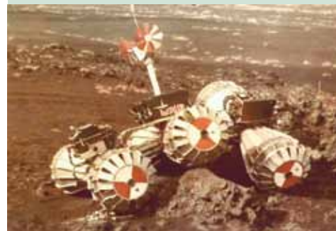
Вторая половина XX века – это также время участия в космических проектах. Конструкторское бюро, занимавшееся разработкой планетоходов, почти наполовину состояло из выпускников кафедры «Колесные и гусеничные машины». На снимке – испытания ходового макета марсохода. Руководитель работ – выпускник кафедры В.В. Громов.
