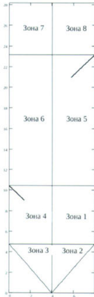
Рисунок 3.16 – Схема разбиения на зоны топки котла ПК-24 ст. № 9 для зонального теплового расчета
