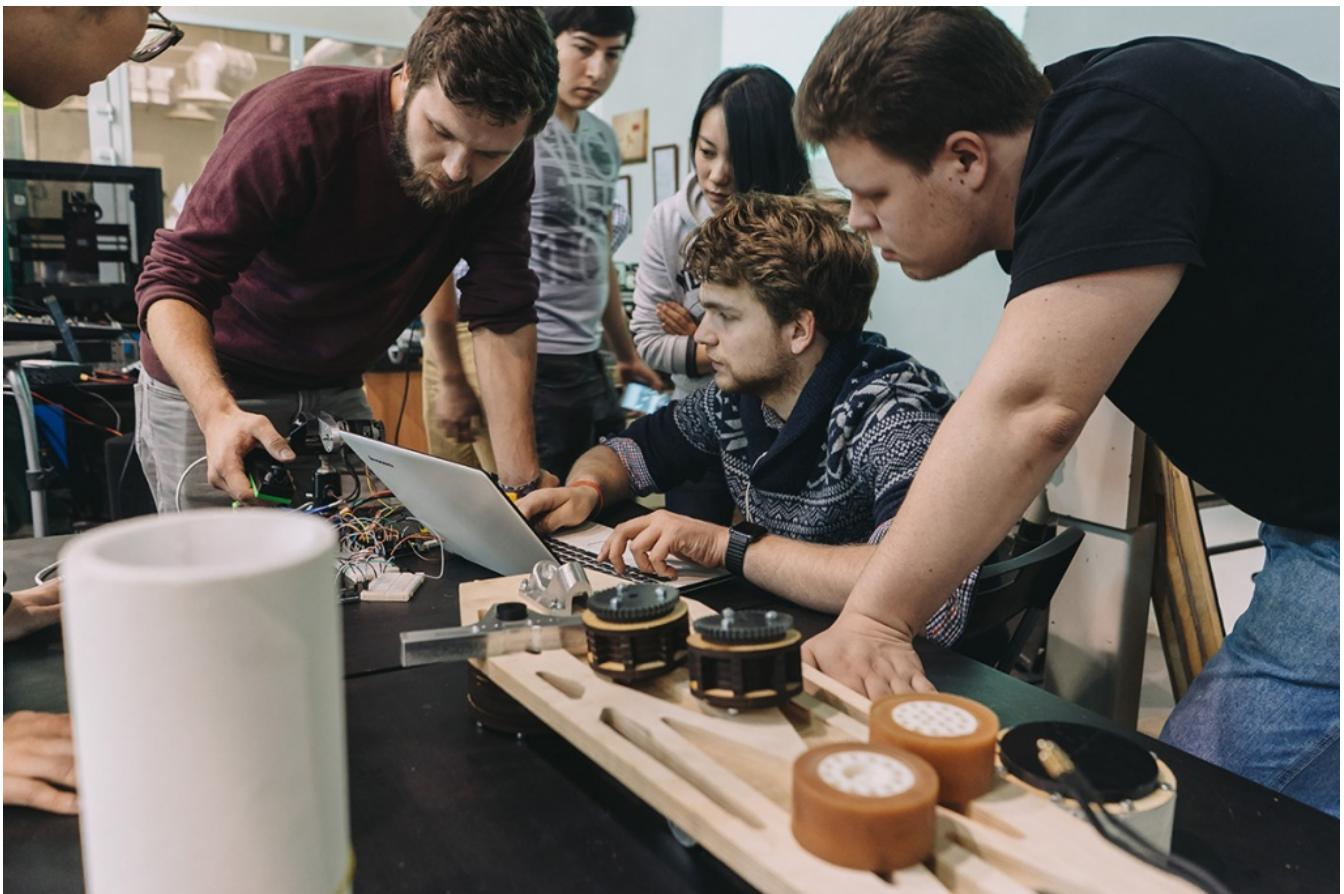
При помощи портативного пульта управляется и второе изобретение – электролонгборд. Всё, начиная с дизайна планки доски и заканчивая отливкой резиновых колес, ребята изготавливали самостоятельно на столярных и лазерных станках, 3D-принтерах, находящихся в Центре научно-технического творчества молодежи СПбПУ. «Дизайн самой доски мы изменяли несколько раз, чтобы найти оптимальное соотношение между небольшим весом и высокой прочностью лонгборда», – поделились ребята.
