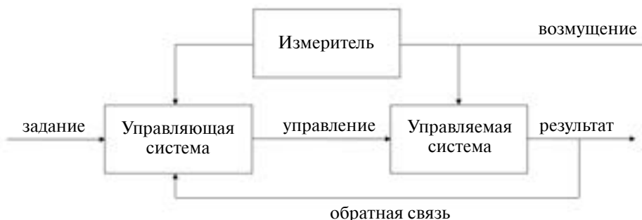
Рис. 44. Комбинированная схема управления
