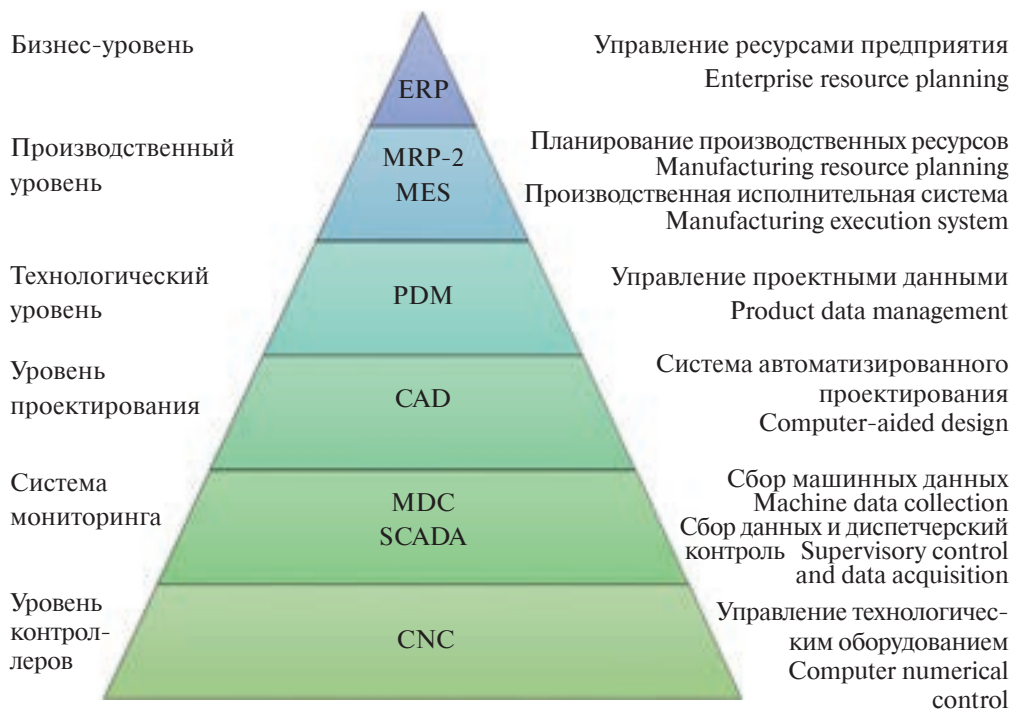
Рис. 22. Пирамида систем автоматизации в управлении оборудованием
