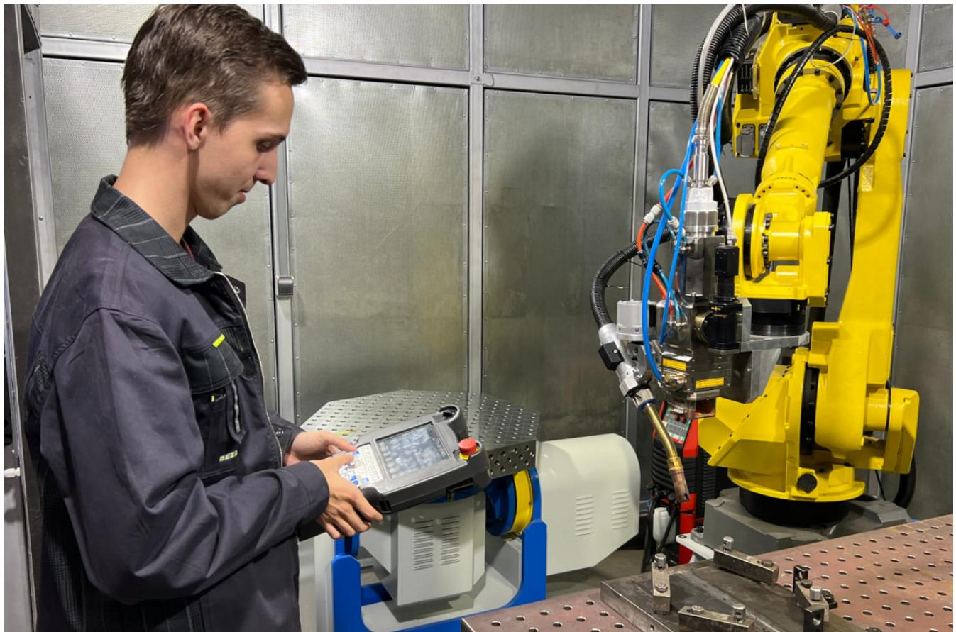
Учёные проводили исследования на роботизированном технологическом комплексе для гибридной лазерно-дуговой сварки. Они оценили остаточные деформации при разных видах сварки: лазерной, гибридной лазерно-дуговой, лазерной с присадочной проволокой, односторонней и двусторонней ручной дуговой и механизированной полуавтоматической в активных газах и смесях образцов из стали марки Ст3 толщиной 10 мм.
