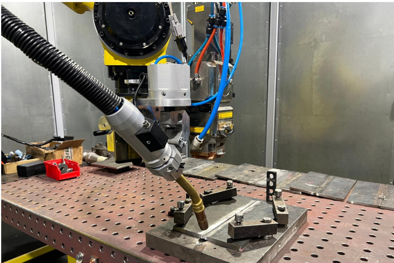
Специалисты провели металлографическое исследование образцов, полученных при различных способах сварки, и сделали сравнительный анализ остаточных деформаций методом 3D—сканирования. Оказалось, что меньше деформации происходит при гибридной лазерно-дуговой сварке, а больше всего — при односторонней ручной дуговой.
