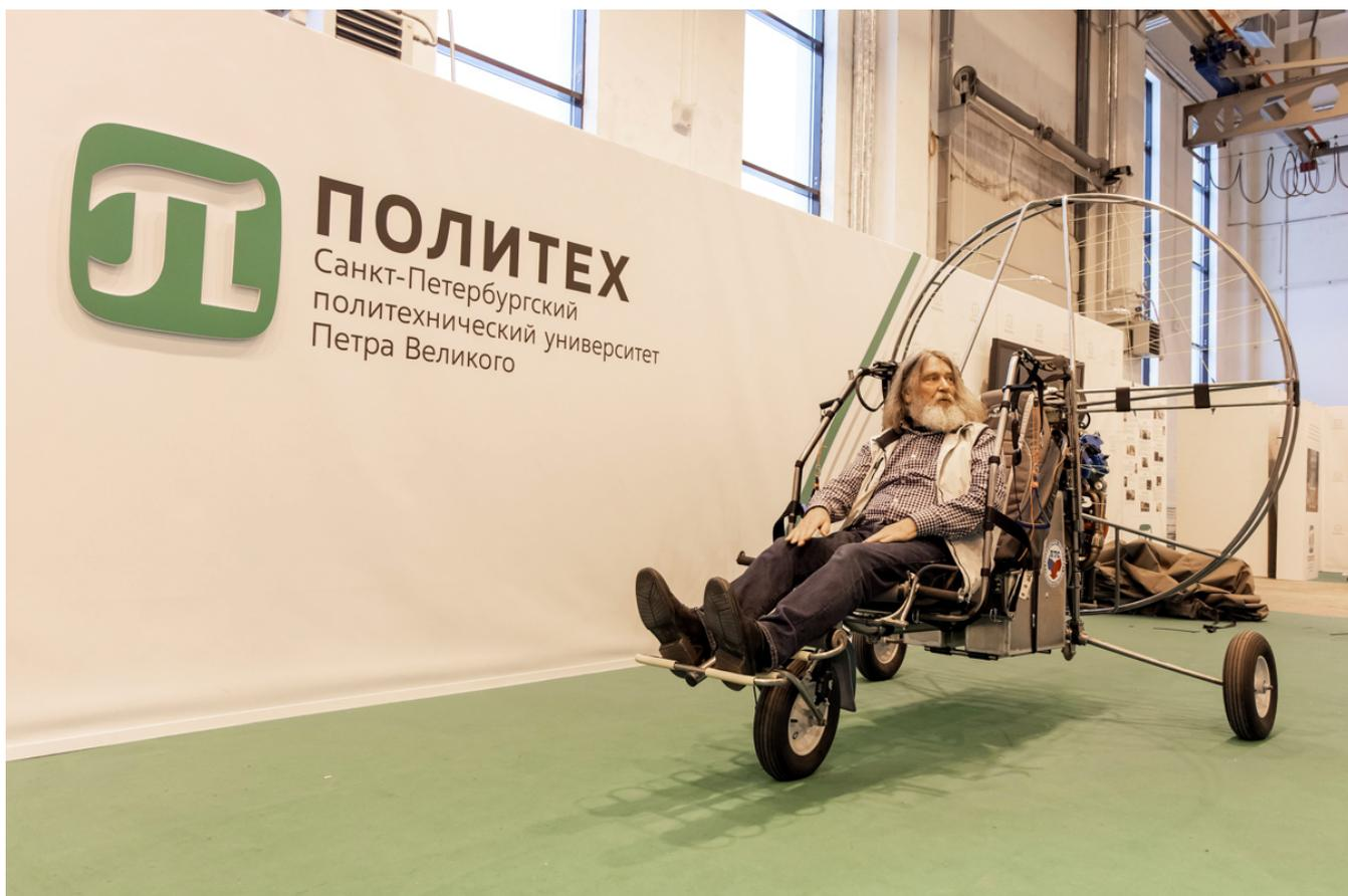
В конце прошлого года паралёт доставили в Политех для выполнения 3D-сканирования с последующим формированием геометрической 3D-модели для дальнейшего проектирования обтекателя под заданные требования и ограничения.
