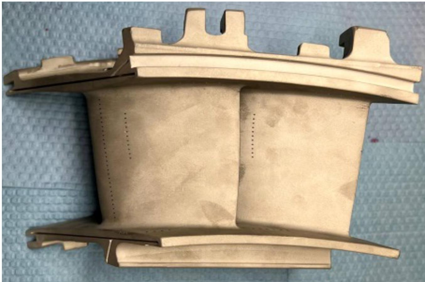
Также специалисты провели экспериментальные исследования свойств компактных образцов и разработали технологический процесс ремонта деталей, включающий термическую обработку, механическую обработку и лазерную наплавку, входной и выходной контроль.
