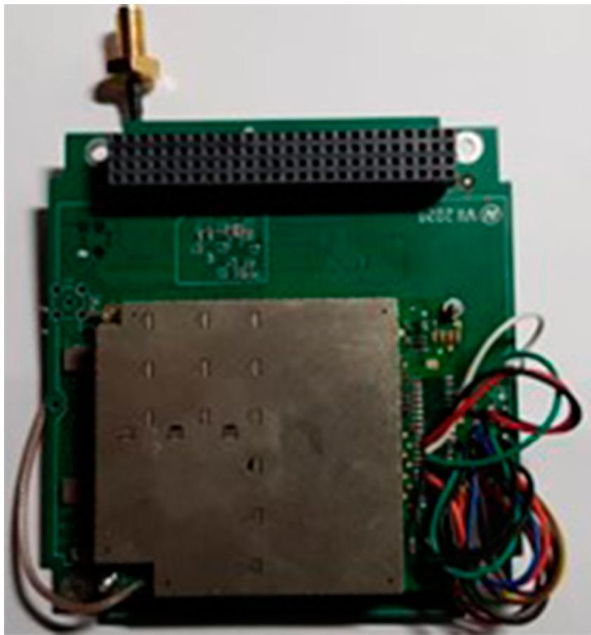
В институте электроники и телекоммуникаций СПбПУ разработан приёмник АИС (габариты 95×95×15 мм). Запуск космических аппаратов планируется в конце этого года с космодрома «Восточный». Напомним, что СПбПУ уже участвовал в запуске трех микроспутников, успешно выполнивших свои миссии.
