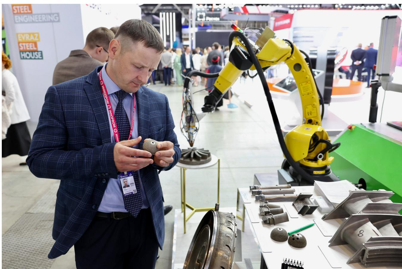
Также на стенде можно увидеть сопловые аппараты после восстановительного ремонта методом лазерной газопорошковой наплавки, рабочие и сопловые лопатки, сварные соединения, образованные методом лазерной и гибридной лазерно-дуговой сварки и многое другое.
