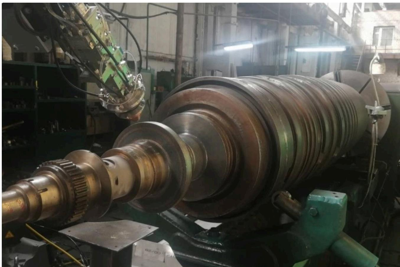
Также в ходе работ был проведен комплекс испытаний наплавленных образцов в испытательном центре «ПолитехТест» (сертифицирован «ИнтерГазСерт»), подтвердивших высокие механические характеристики наплавленного слоя (на уровне механических характеристик основного металла ротора). Ведущий инженер НОЦ «Конструкционные и функциональные материалы» Михаил Кузнецов пояснил, что внедрение технологии лазерной наплавки компонентов газоперекачивающих агрегатов
