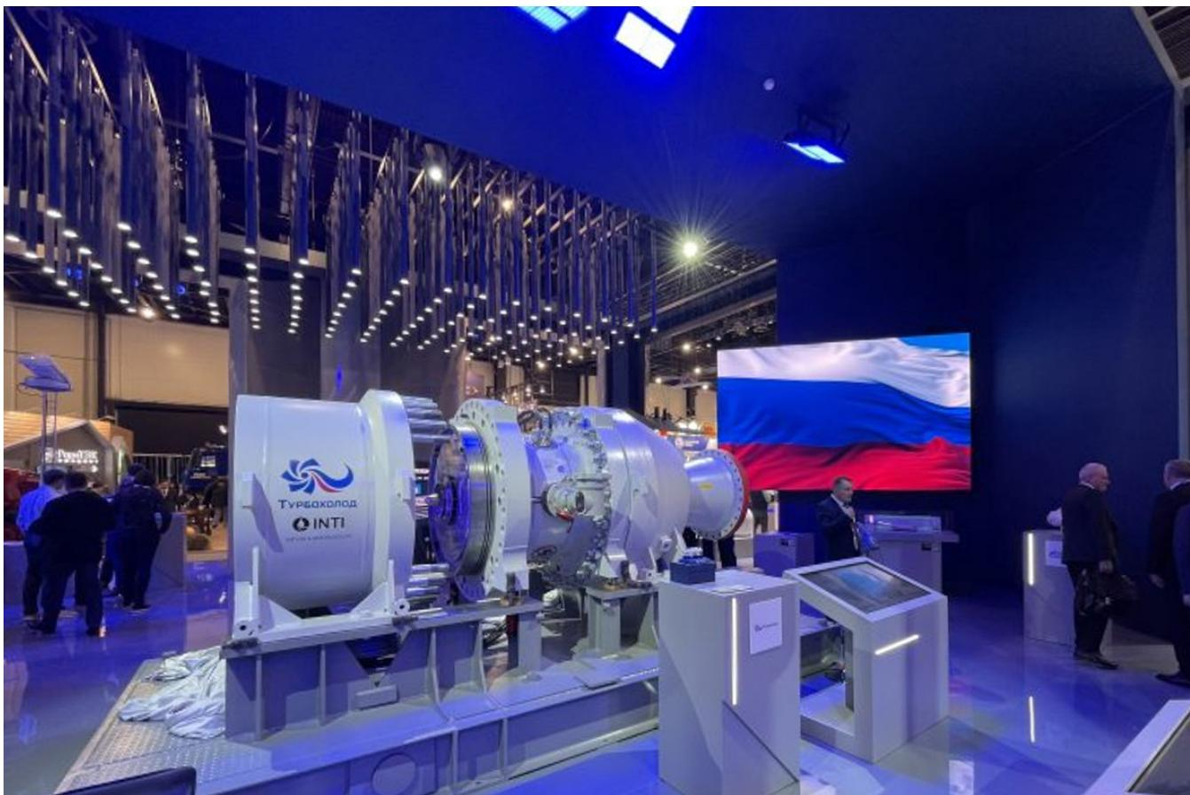
ТДА АДКГ-40 — машина нового поколения с техническими характеристиками, превосходящими мировой уровень благодаря совершенной конструктивной схеме и турбины, и компрессора. Агрегат предназначен в первую очередь для объектов переработки газа, включая заводы по производству сжиженного природного газа. Испытания подтвердили КПД радиальной турбины (ТБХ) 87 % и центробежного компрессора (СПбПУ) 88 %.
