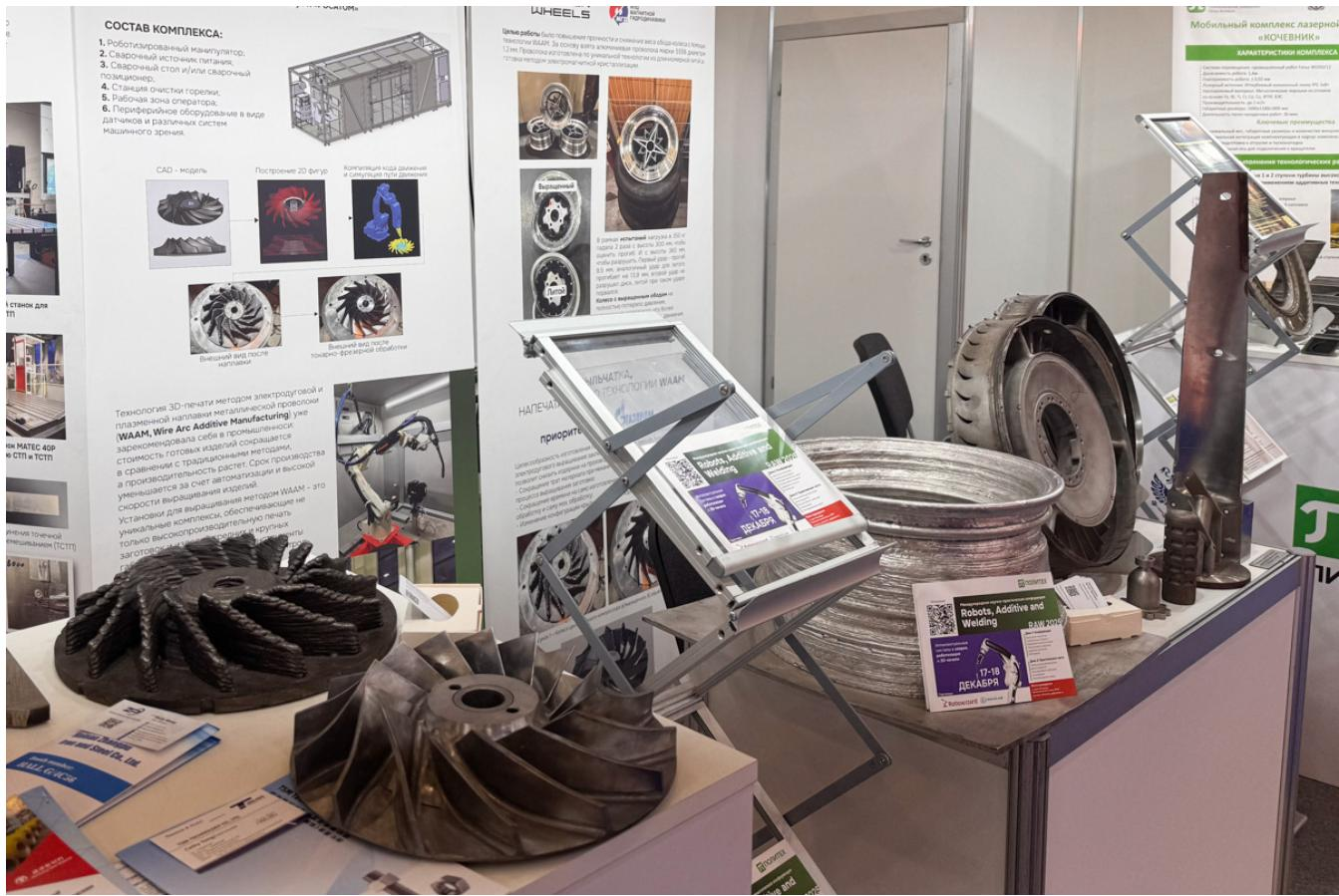
Специалисты НИЛ «ЛиАТ» продемонстрировали промышленные образцы, созданные с использованием лазерной наплавки, гибридной лазерно-дуговой сварки и прямого лазерного выращивания. Среди представленных решений — восстановленные элементы газотурбинных двигателей, детали энергетического и авиационного назначения, а также образцы сложной геометрии, изготовленные методами аддитивного производства.
