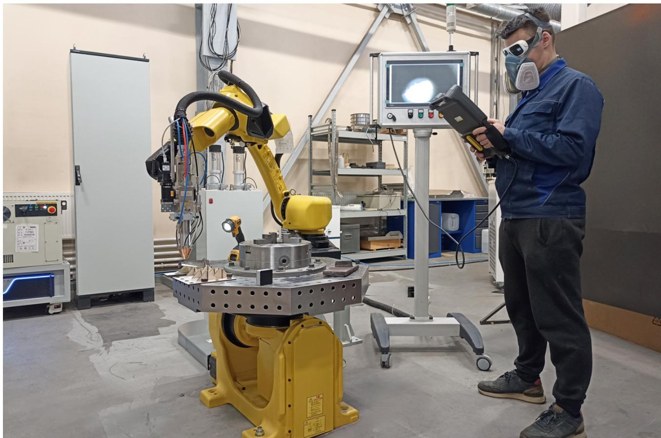
Инженеры НИЛ «ЛиАТ» ИММиТ СПбПУ выполнили практическую часть проекта, направленного на передачу технологий лазерной наплавки при восстановлении элементов газотурбинных двигателей, и провели приёмо-сдаточные испытания ранее поставленного технологического комплекса лазерной порошковой наплавки.
