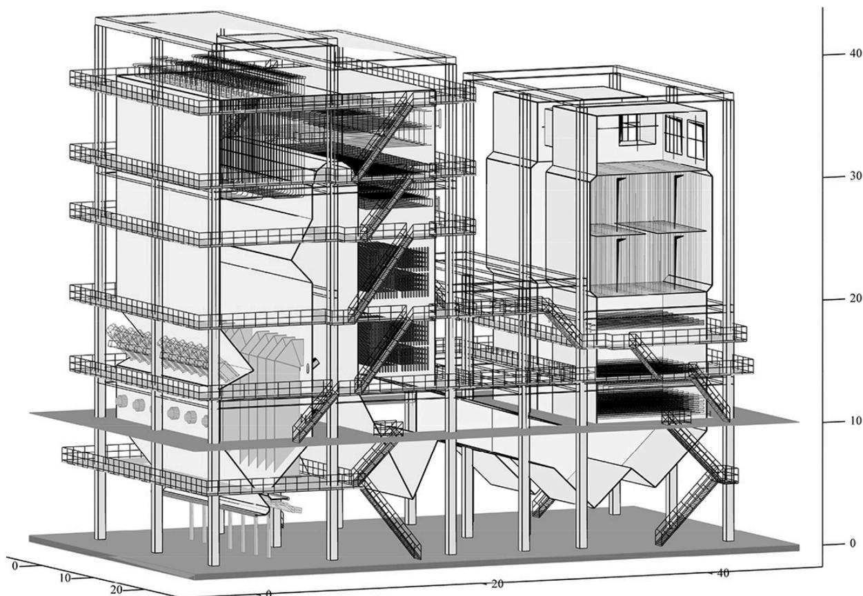
Разработанная технология может быть применима практически ко всем твердым топливам, включая низкосортные (которых в России и во всем мире большие запасы), в том числе местным топливам (сланец, торф и др.). Использование НТВ-метода повышает КПД установки до 90-93%, а количество выбросов оксидов азота снижается до 60%, оксидов серы – до 70%.
