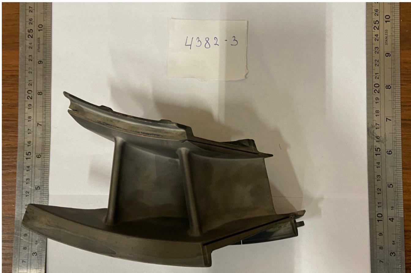
Восстановление элементов соплового аппарата первой ступени ТВД газотурбинного двигателя имеет большое значение для повышения его эффективности и увеличения ресурса. Использование инновационных аддитивных технологий позволяет продлить срок эксплуатации деталей, которые в противном случае пришлось бы заменить. Это снижает затраты на производство, сокращает количество отходов и важно для устойчивого развития отрасли.
