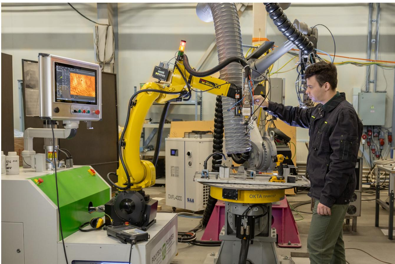
Специалисты НИЛ «ЛиАТ» выполнили работу на мобильном комплексе лазерной наплавки «Кочевник». Для ремонта пера соплового аппарата деталь установили в оснастку, наплавили с двух сторон и провели последующую слесарную обработку. В процессе наплавки операторы устранили трещины, пористость и несплавления.
