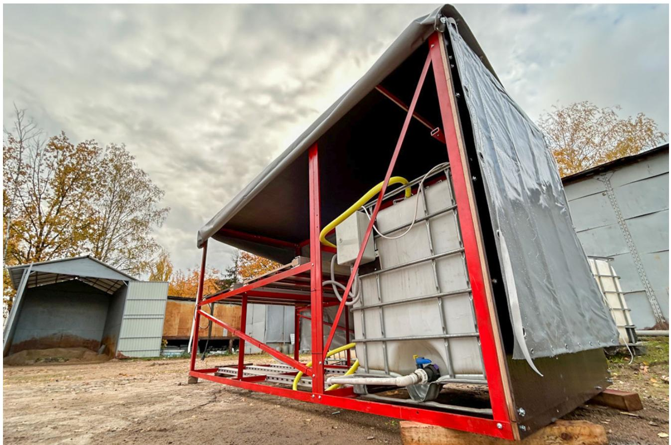
Молодые инженеры спроектировали и изготовили прицеп с габаритами 3,5 м в длину, 1,5 м в ширину и 1,8 м в высоту. Ключевая особенность разработки — комплексное решение для логистики и обслуживания беспилотников. Модуль обеспечивает операторов всем необходимым для быстрой выгрузки и погрузки дронов, подготовки к полёту, а также
