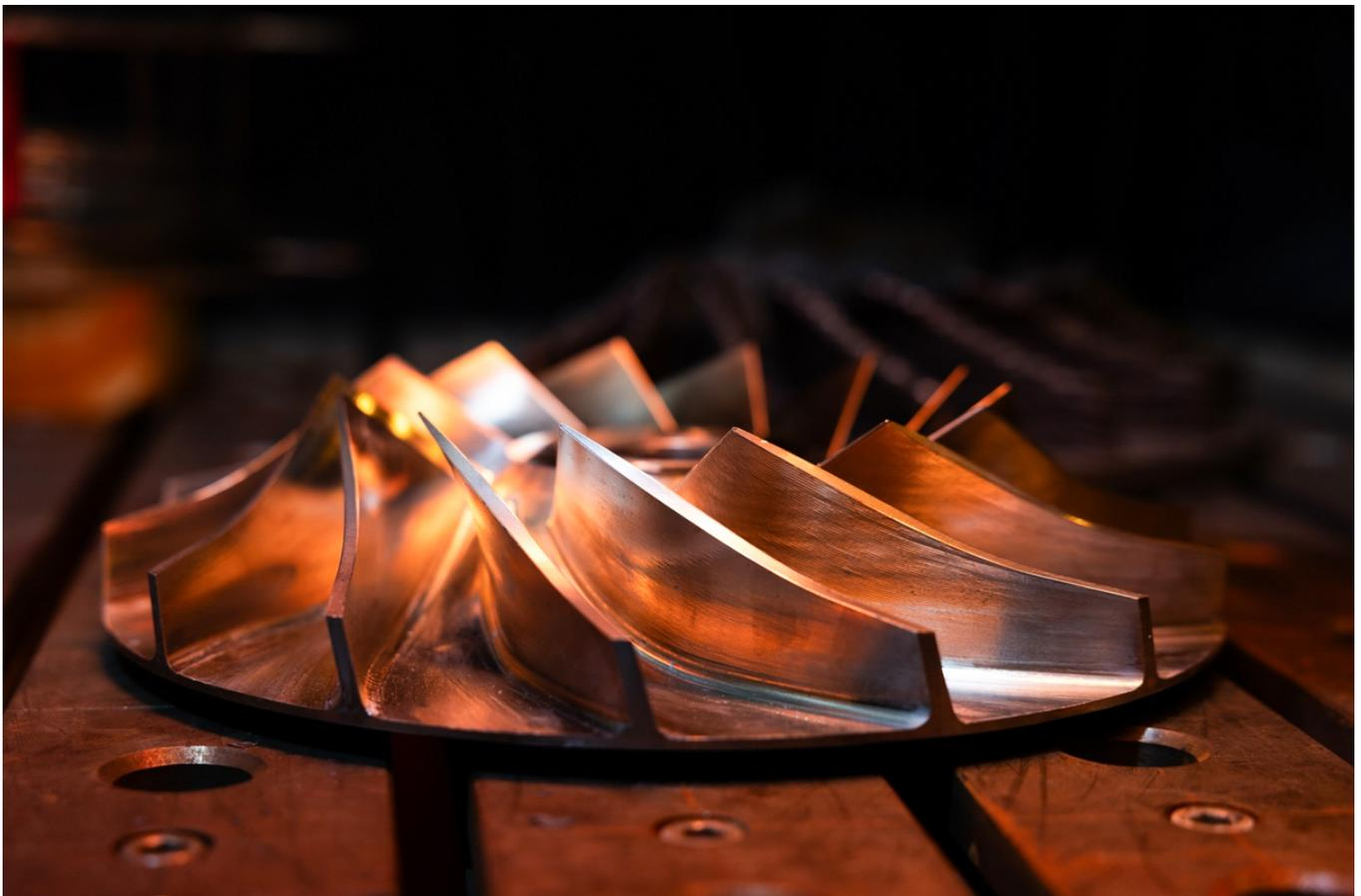
Изготовленный в лаборатории Политеха образец успешно прошёл серию стендовых испытаний, условия которых были аналогичны эксплуатационным. Крыльчатку раскручивали до 18 тысяч оборотов в минуту.
