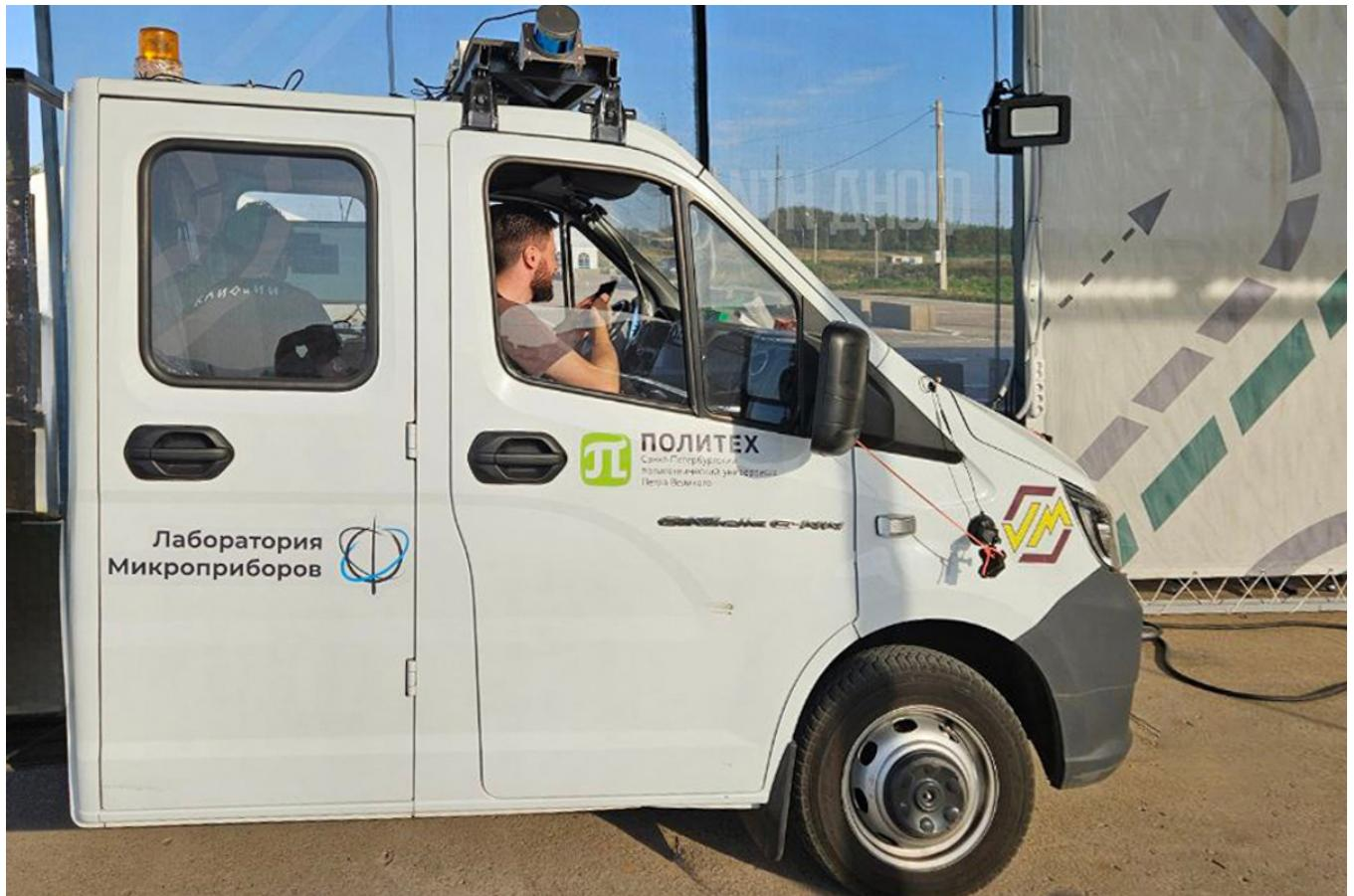
Команда Политеха разработала весь комплекс управления штатными системами автомобиля: рулевое управление, педаль акселератора, тормозная система, селектор переключения режимов движения и световая техника. Отдельно стоит отметить разработанную схему управления электроусилителем руля, позволяющую автомобилю совершать сложные
