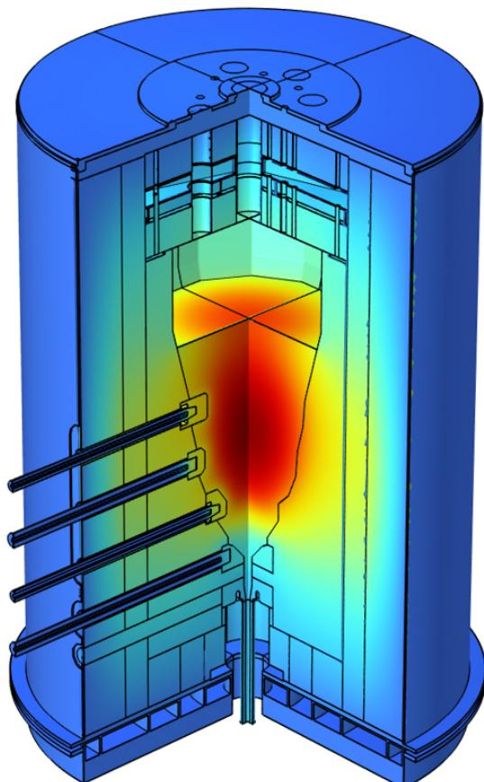
Технология остекловывания — это мировой стандарт утилизации жидких радиоактивных отходов. Спекание в специальной печи при температуре выше 1000 градусов превращает отходы в твёрдое стеклоподобное вещество. Такой подход решает две ключевые задачи: во-первых, сокращает исходный объём опасных материалов за счёт удаления жидкой составляющей, а во-вторых, заключает их в химически устойчивую
