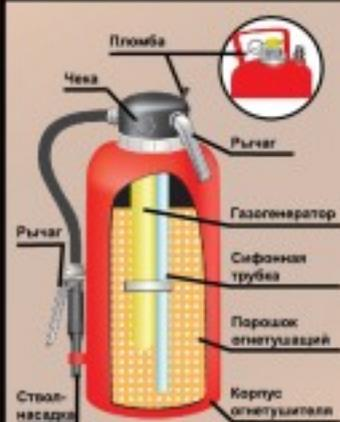
Устройство заряженное огнетушащим порошком и закачанное газом (воздухом, азотом или углекислым газом). Корпус и заряд огнетушащего вещества постоянно находится под давлением.
