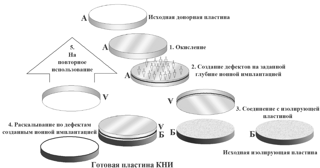
Рисунок 1.12 Основные этапы технологии Smart Cut французской фирмы Soitec Group
