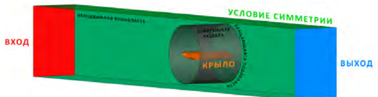
Рис. 65. Расчетная область и граничные условия.
