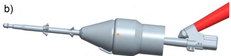
Рис. 151. Установка модели КГЧ на державке в рабочей части аэродинамической трубы Т-128: фото (а) и САД модель (b).
