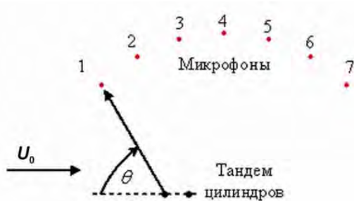
Рис. 118. Схема расположения микрофонов в экспериментах QFF.
