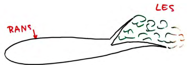
Рис. 11. Схема, поясняющая функционирование DES при расчете течений с обширным отрывом (Ф. Спаларт, 1997 год).
