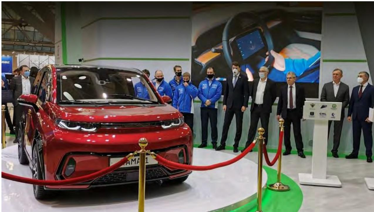
Зарядка от бытовой розетки занимает шесть часов, от «быстрой» колонки всего 20 минут (тут, скорее всего, речь про достижение 80%). Предусмотрен автопилот [третьего уровня](#). На рулевой колонке размещён неподвижный девятидюймовый экран. Это и приборка, и средство управления мультимедийной системой, помощниками водителя (ADAS) и «климатом». Есть проекционный дисплей.
